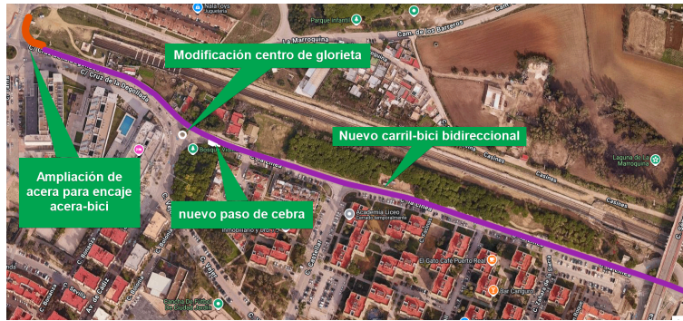
Delimitación en planta de carril bici bidireccional y afectación a centro de glorieta, además de acera-bici oeste a resolver
