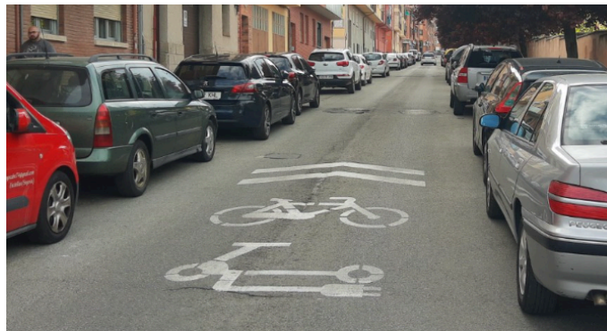
Ejemplo de señalización horizontal en ciclocarril, en Segovia
