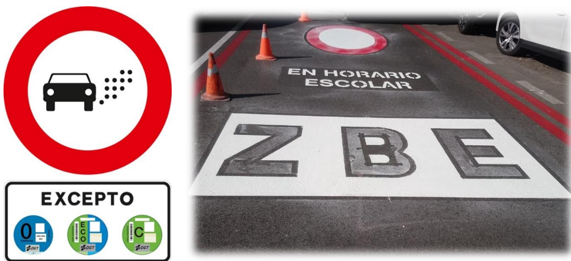
Figura 163. Señales verticales y horizontales en los accesos a las Zonas de Bajas Emisiones.
