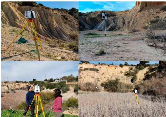
Figura 3. Equipamiento del LiDAR Leica ScanStation P50 (scáner y dianas de control) y trabajos de campo.
