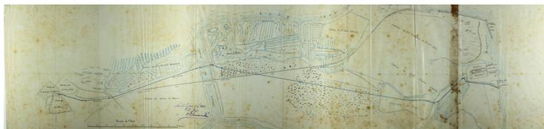
*Imagen 2: Trazado del tranvía proyectado entre la Fábrica de gas y el Dique de Matagorda. Firmado por Jean Pierre Prouvat de Guery el 3 de octubre de 1888. AMPR, 224-5 Tranvía desde el Dique a Puerto Real 1888.*
